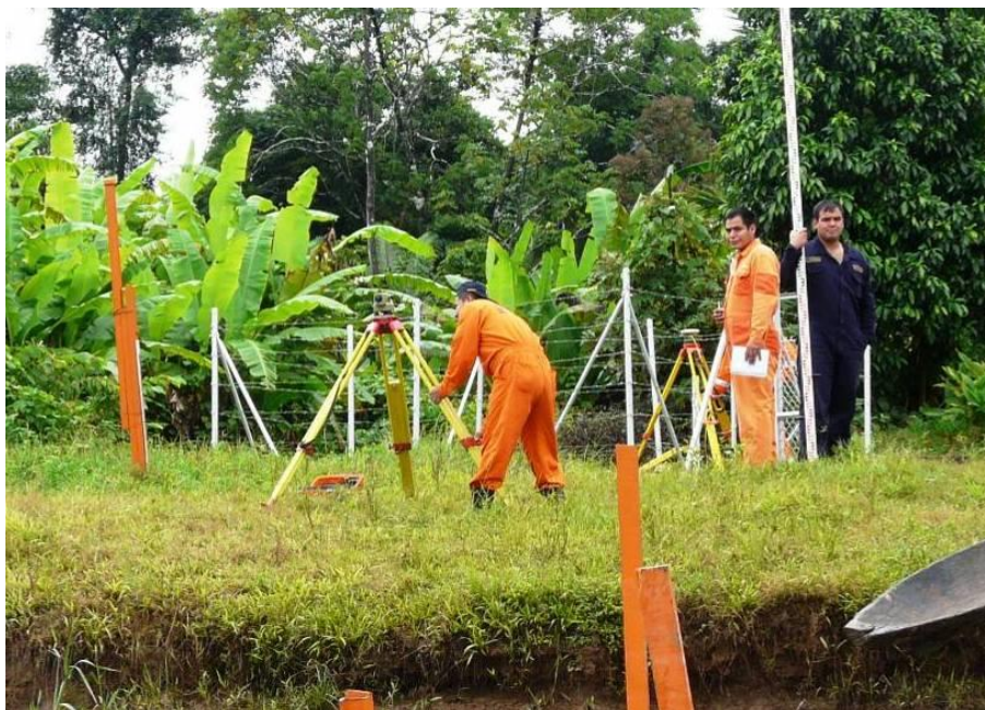
Fotografía 05.- Efectuando nivelación diferencial y rastreo satelital en una estación hidrometeorológica colombiana de San Agustín.
