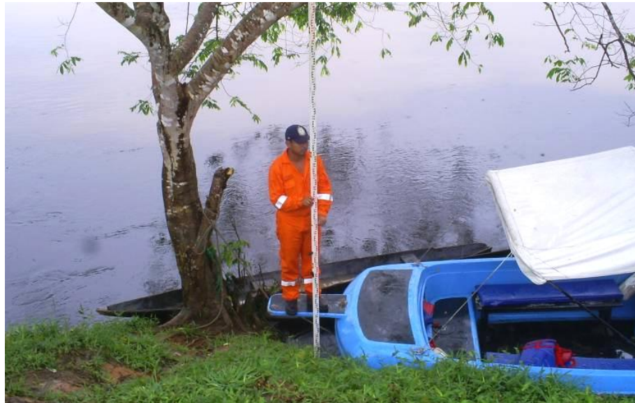
Fotografía 09.- Nivelación diferencial en el poblado Nueva Esperanza
