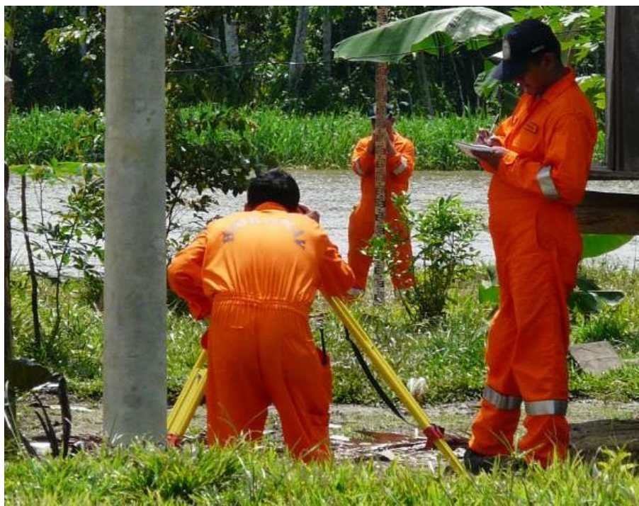
Fotografía 08.- Nivelación en el poblado Remanso desde el BM Sirgas hasta el espejo del agua.
