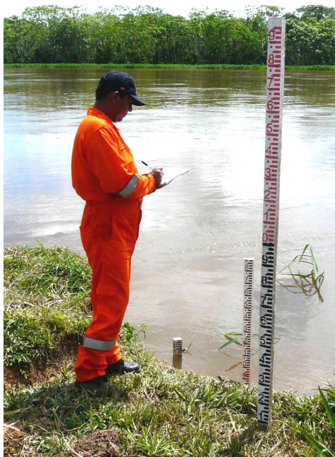
Fotografía 07.- Registrando el nivel del río en la estación limnimétrica Remanso.
