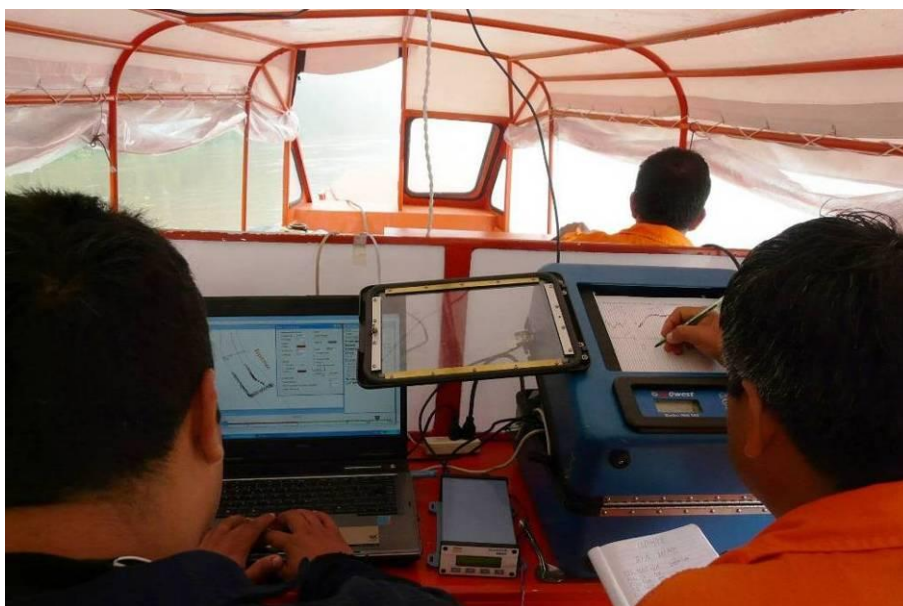
Fotografía 11.- PC portátil, DGPS y ecosonda empleados en la batimetría de secciones transversales y el canal de navegación.
