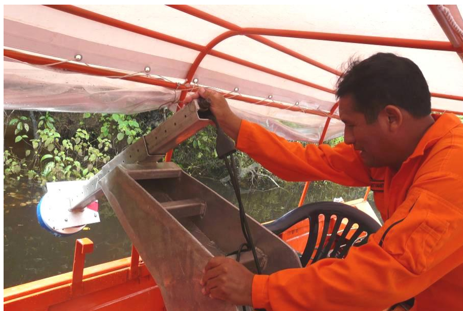
Fotografía 14.- Preparando el ADCP para efectuar aforos líquidos en el río Angusilla.
