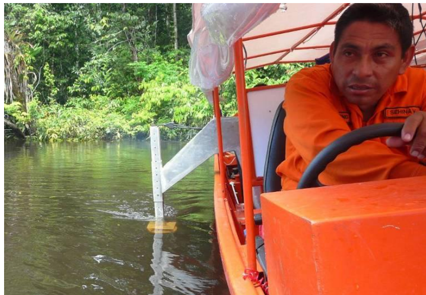
Fotografía 16.- Embarcación HIDRO V, con el ADCP dentro del agua en el río Campuya.
